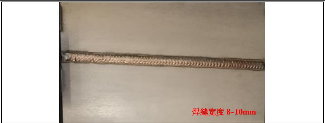
图 2-1 前处理电泳槽体产品及其焊缝示例
