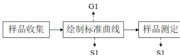
图 2-5 直接进样-气相色谱法测定二氯甲烷实验流程及产污环节图
