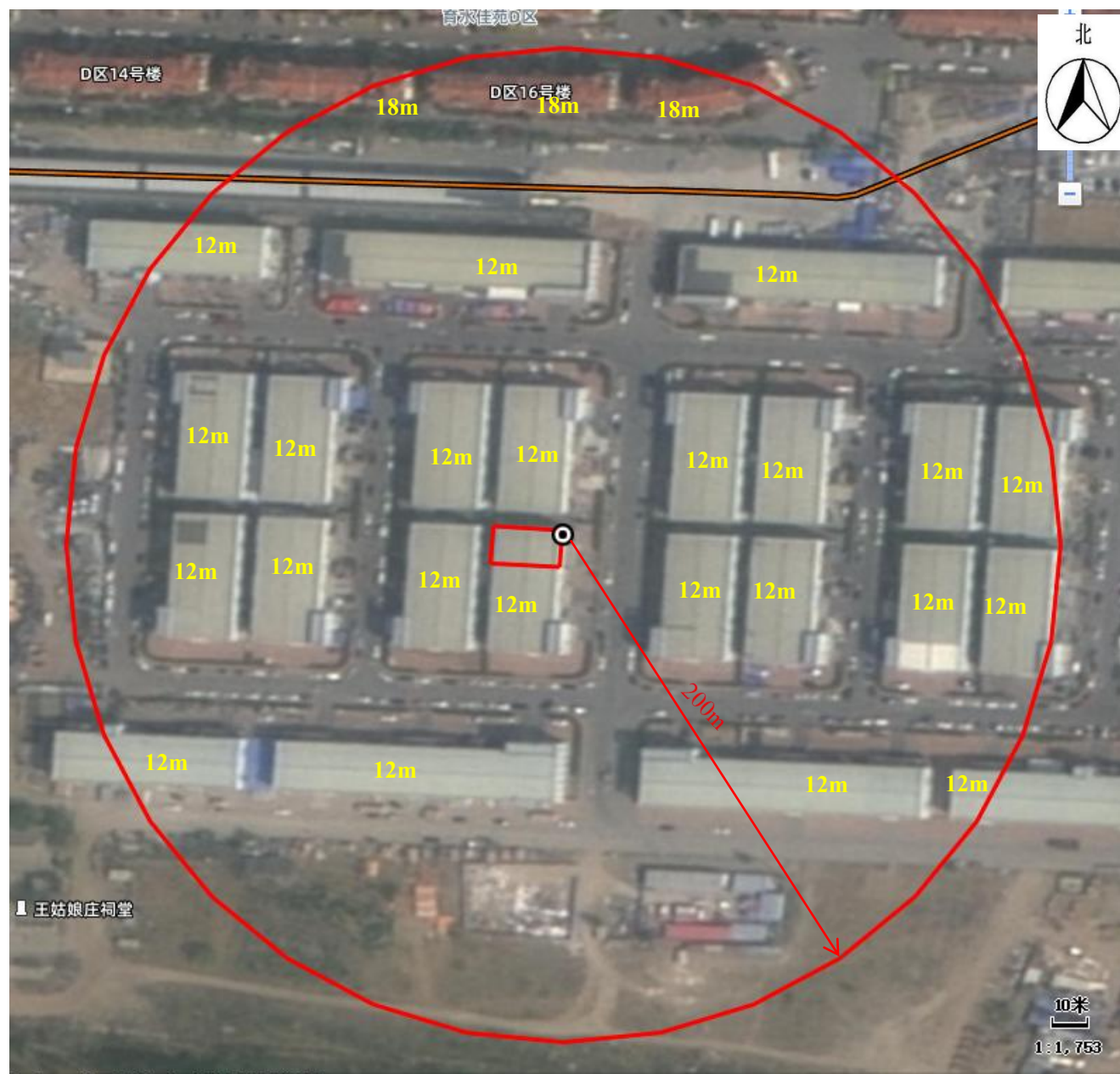
附图 11 排气筒周边 200m 建筑物高度图
